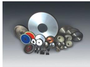
陶瓷结合剂金刚石和CBN砂轮与金属结合剂金刚石和CBN砂轮相比，具有更好的弹性、锋利性和可修整性，与树脂结合剂金刚石和CBN砂轮相比，又具有更好的形面保持性、热稳定性和更长的磨削寿命。陶瓷结合剂金刚石砂轮适用于硬质合金、陶瓷制品、玻璃制品、PCD、PCBN、CVD、天然金刚石、宝石材料等的精密加工。陶瓷结合剂CBN砂轮适用于铸铁材料、轴承钢、高速钢、工具模具钢、耐热合金钢等金属材料的精密加工。
