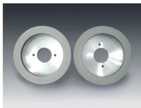
该砂轮由低温陶瓷结合剂与优质选型的高强度CBN烧结而成。磨削锋利，耐用度高，磨削质量好，易修整。可提供致密型和气孔型各种规格，常用粒度为500# - 4000#，满足粗、精、超精刃磨加工。
