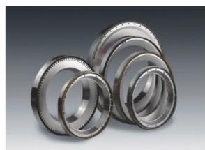
硅片减薄砂轮主要用于半导体晶圆(硅片或其他半导体材料)的背面减薄或正面精密加工。赛力生产的此类砂轮分为树脂结合剂和陶瓷结合剂两大类。其特点为磨削锋利、保持性好、磨削效率高、使用寿命长。
